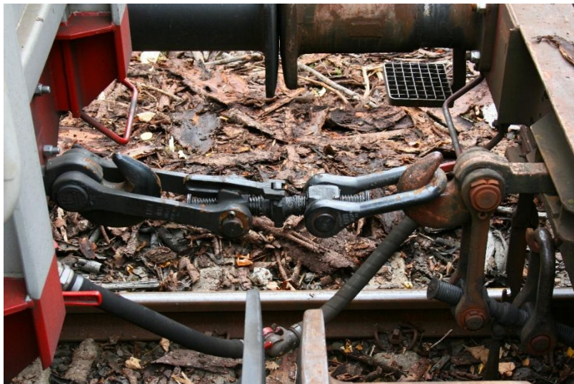
Gekuppelte Wagen mittels Schraubenkupplung
